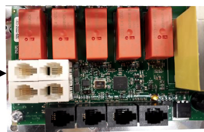
Rysunek 5 Kolejność złączy RJ 10. Czujnik, przełącznik drzwiowy, sterowanie zdalne, dodatkowe NTC
